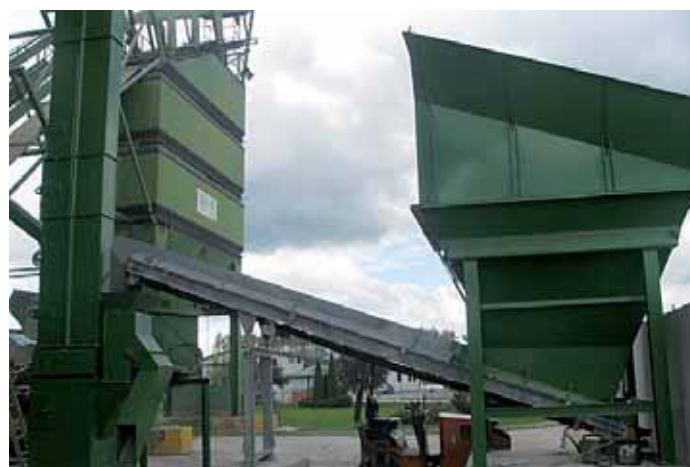
Slika 6. Pogled na predozator reciklažnog asfaltnog agregata
