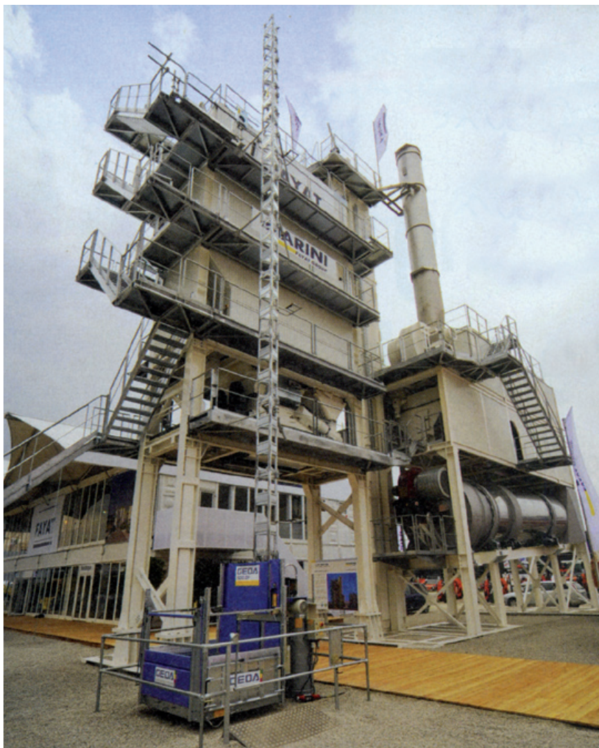
Novi TOP Tower TT4000 model tvrtke Marini može proizvoditi sve vrste vrućih, toplih i polu-toplih asfaltnih mješavina
