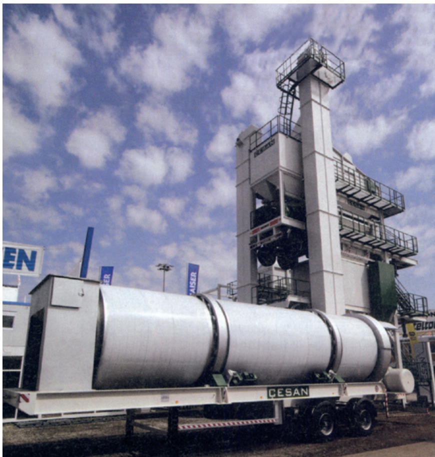
Mobilna asfaltna baza turskog proizvođača CESAN na pet etaža
