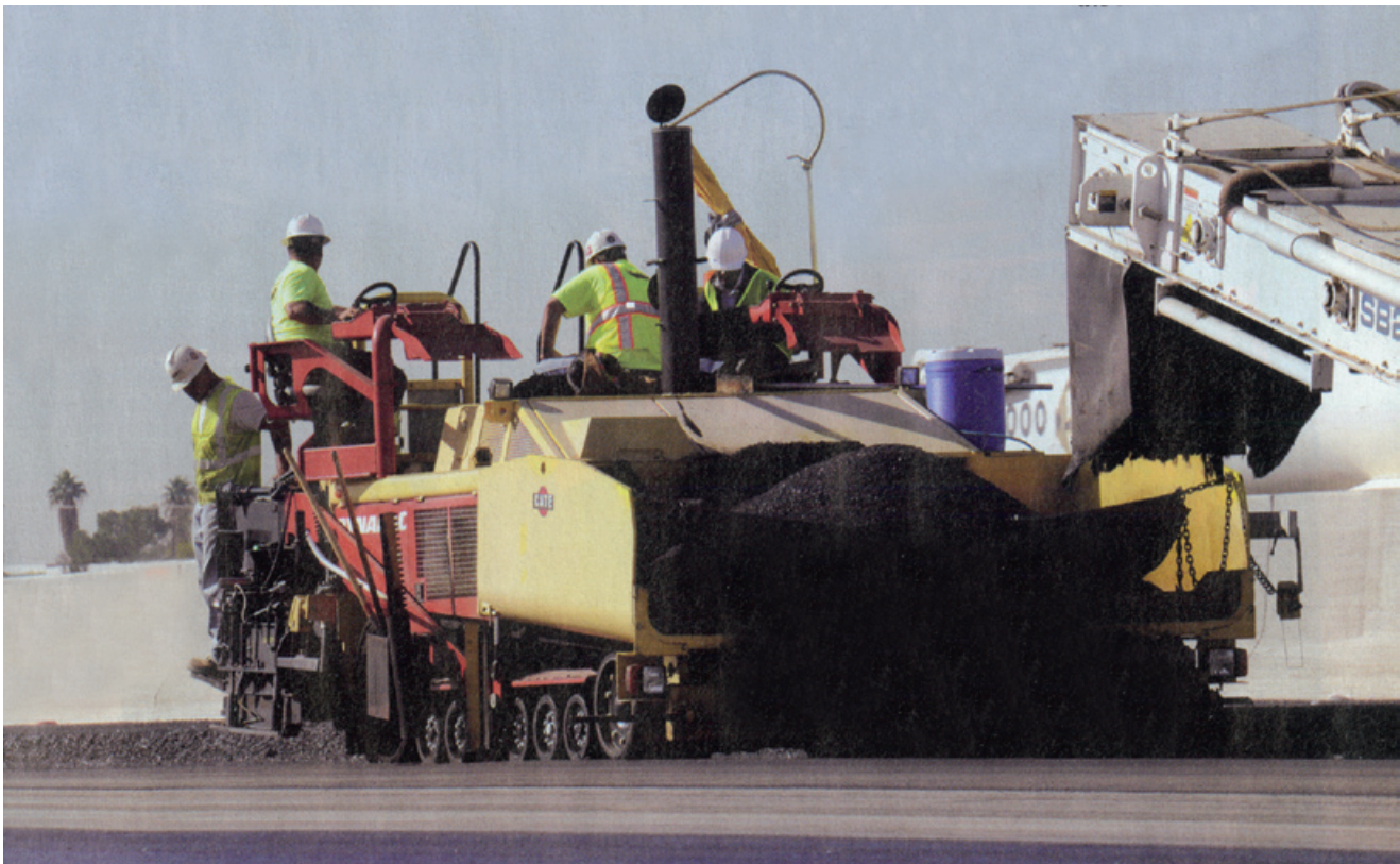
Dynapac američkim kupcima sada nudi novi finišer serije F1000 na kotačima i gusjenicama koji ugrađuje asfalt u širini 3 metra
